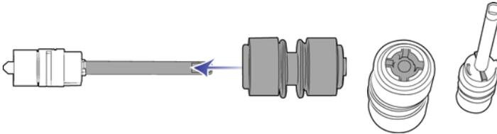
9. Inserte el extremo redondeado del rodillo en la ranura del escáner. Baje con cuidado el rodillo hacia el interior del escáner. Asegúrese de que la ranura del lado derecho de la barra esté alineada de forma que se deslice en su lugar en la forma de U del soporte.
