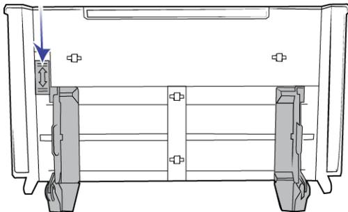
Cuando el botón de la guía del papel se encuentre hacia abajo, las guías del papel se podrán ajustar a un ancho máximo de 216 mm (8,5 pulgadas). Si las guías del papel se ajustan con un ancho superior al máximo para un papel normal, los documentos podrían desviarse en exceso durante el escaneo.
