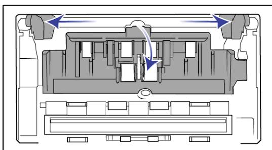
**Nota:** Si las guías del papel se encuentran delante la tapa del rodillo al abrirla, se soltarán automáticamente del cuerpo del escáner. Si esto sucede, siga las instrucciones de la página 38 para restablecer las guías del escáner.
