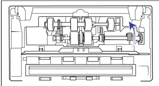
9. Levante la tapa del rodillo y empújela con cuidado para colocarla en su lugar. Asegúrese de que todo esté correctamente alineado y que la tapa esté completamente cerrada. Si la tapa no está completamente cerrada, se romperá durante el escaneo y el escáner se estropeará.
