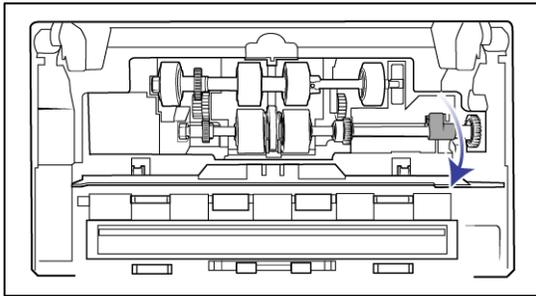
5. Tire con cuidado del rodillo hacia arriba y hacia fuera del escáner y, a continuación, deséchelo, ya que no se puede reparar.
