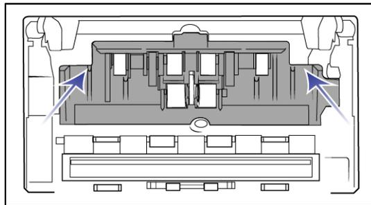
10. Asegúrese de que las guías del papel estén correctamente colocadas en el escáner.
