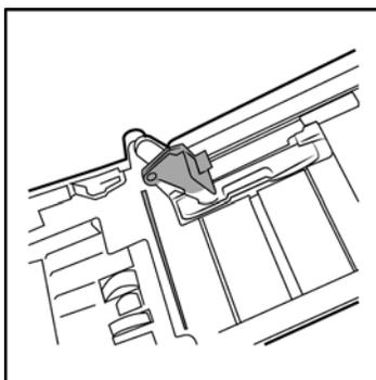
4. El rodillo inferior se mantiene en su posición mediante una lengüeta de bloqueo que gira para bloquearlo y desbloquearlo. Para desbloquear la lengüeta, gírela hasta que la pestaña de bloqueo pequeña esté completamente libre.
