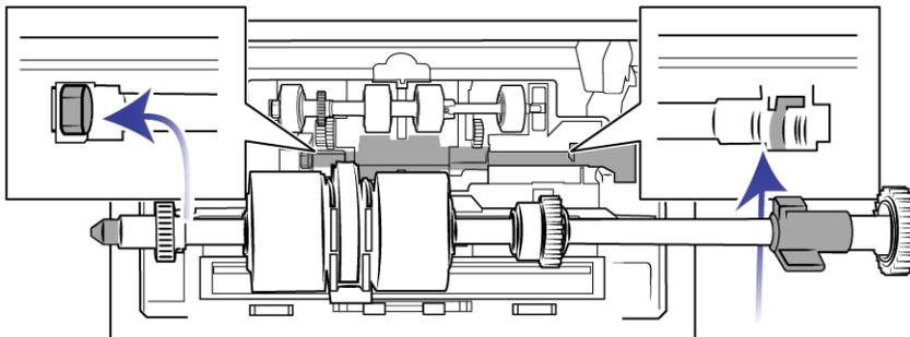
8. Gire la lengüeta de bloqueo en la ranura del escáner. Presione la palanca hasta que se coloque en su lugar con un clic y bloquee el rodillo en el escáner.
