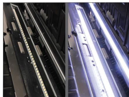
**Barre lumineuse :** un dispositif lumineux de pointe permet d'augmenter l'intensité de la source lumineuse de 1 DEL à 45 DEL, fournissant ainsi une excellente lumière produisant des images de qualité supérieure.
